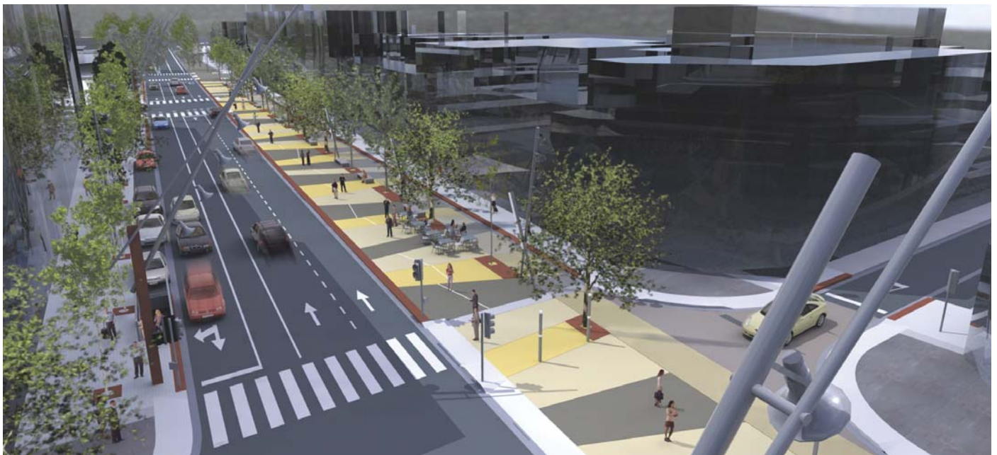
La nova avinguda tindrà una rambla, dues voreres i tres carrils principals destinats al trànsit i un altre per als serveis
